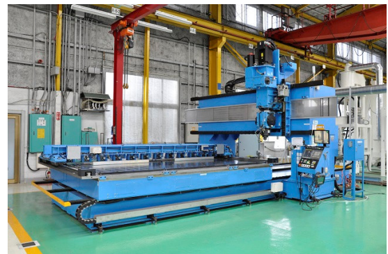
<菊川所有の大型摩擦撹拌接合（FSW）装置>
