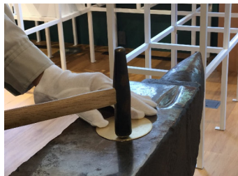
<加工体験コーナーでミニ・シンバルに槌目加工を施していく様子>
