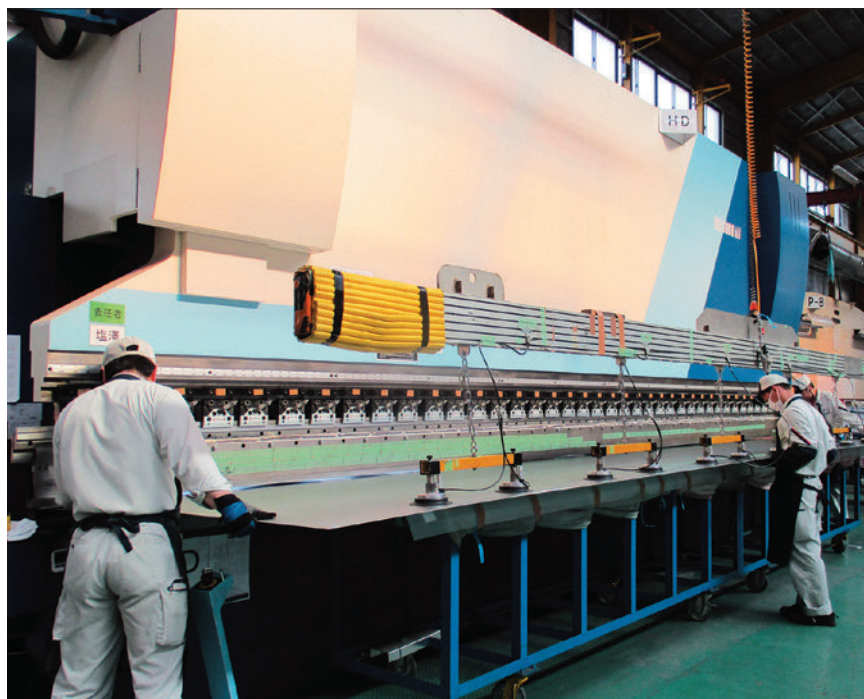
最大加工サイズ8mを実現した業界最大規模の特注ベンダー（金属プレス）設備
