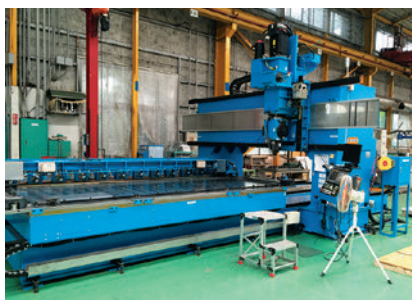
最新鋭のFSW (摩擦攪拌接合装置)
