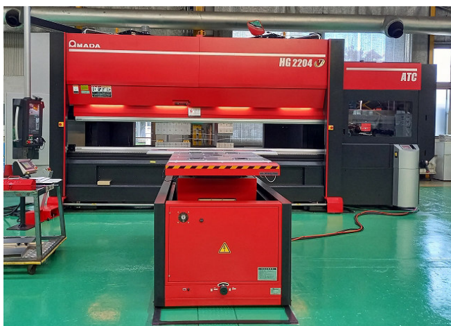
<新ベンダー全景：右側に自動金型交換装置が付帯>
