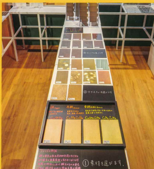
上：「Studio K+」では、サンプルを実際に見ながら研磨の種類や仕上げを比較検討することができる。銅の含有率が高ければ高いほど柔らかく、赤みを帯びた色になる。/右：サンプル例の一部。
