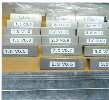
写真3 溝入れによる曲げ加工
