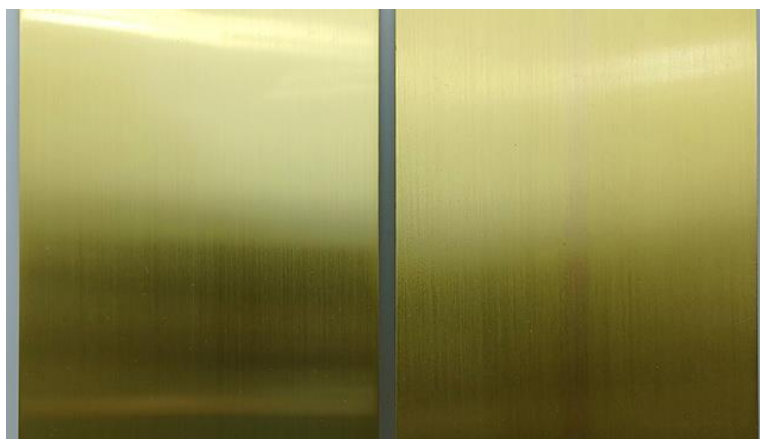
左：新開発手法でのレーザー溶接 右：従来のTIG溶接 （どちらも溶接後にHL仕上げ）従来品は溶接跡が変色しているが、 新開発手法では中央の溶接跡がほとんど目立たない。
