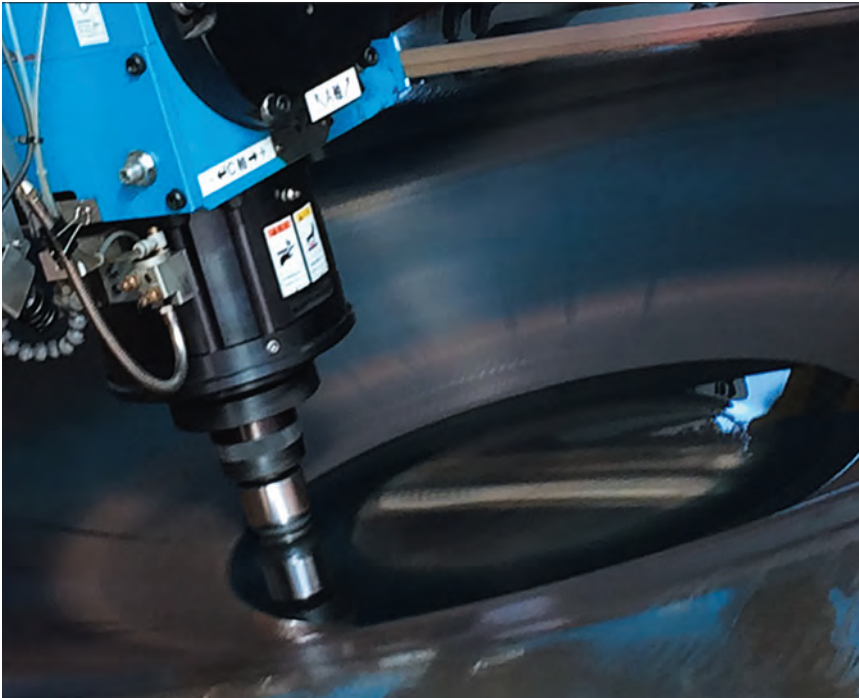
成形工具を回転させながら金属薄板に押しつけ、逐次塑性加工することで得られる自由な形状
