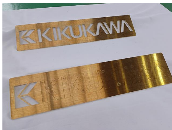
▲新レーザ切断機で加工した真鍮板サンプル。CO 2 レーザに比べファイバーレーザのほうが加工スピードが速いため、熱伝導率の高い素材でも高品質の加工が可能。
